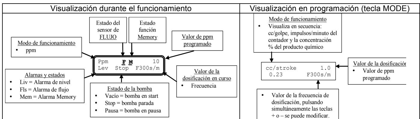
Párrafo 8 – Dosificación temporizada (**Entrada señal de frecuencia “TRIGGER” activada**)
